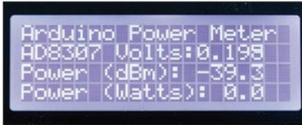
**Fig. 4: Power meter display.**
