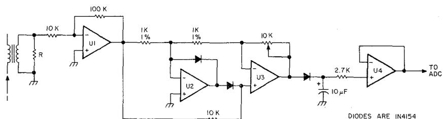
Fig. 4. Precision rectifier/buffer.
