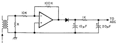
Fig. 5. Half-wave rectifier.
