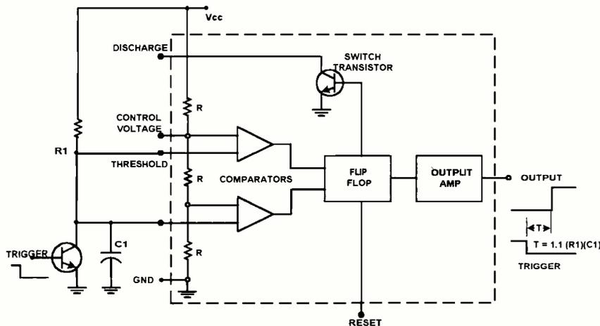
FIG 8 TIME DELAY OPERATION OF NE555 TIMER
