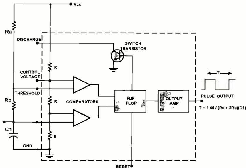
FIG 6 ASTABLE OPERATION OF NE555 TIMER
