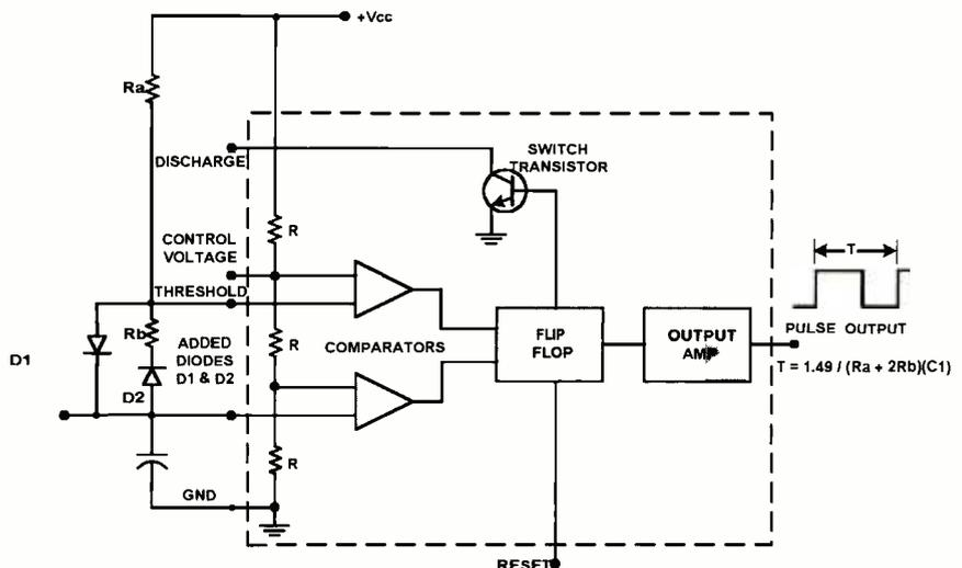
FIG 7 ASTABLE OPERATION OF NE555 TIMER WITH DUTY CYCLE CONTROL
