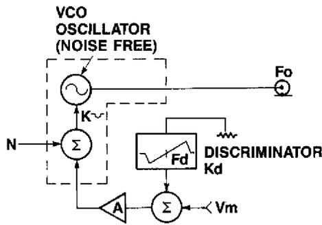
**N** IS THE EQUIVALENT VOLTAGE WHICH RESULTS IN THE NOISE POWER SPECTRAL DENSITY OF THE OSCILLATOR
