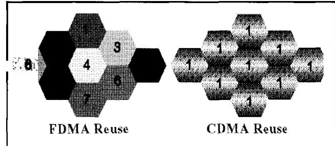
Figure 2. Cellular frequency reuse patterns. (a) FDMA reuse. (b) CDMA reuse.
