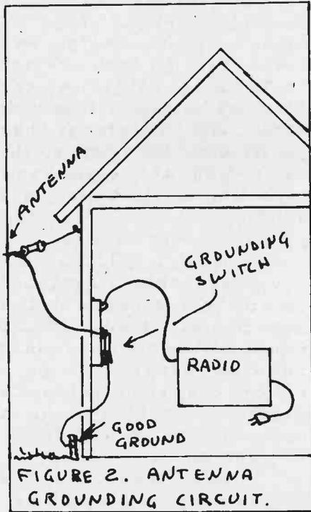
**FIGURE 2. ANTENNA GROUNDING CIRCUIT.**
