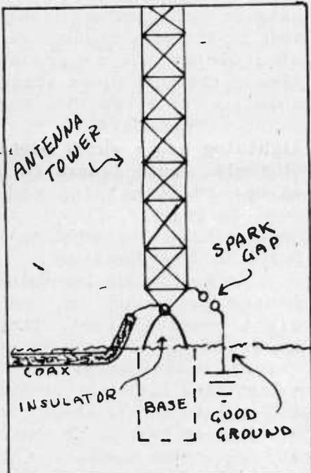
**FIGURE 1. SPARK-GAP TYPE LIGHTNING ARRESTOR USED ON UNGROUNDED TOWER. COAXIAL CABLE BRAID CONNECTS TO BURIED RADIALS [NOT SHOWN]**
